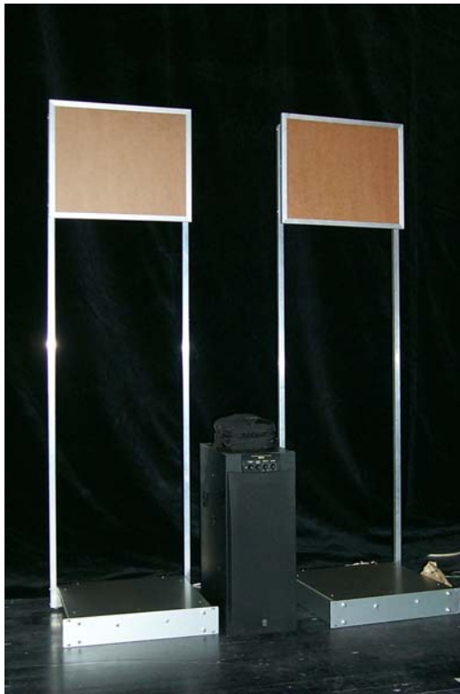
„ZsonicPanels“: moderne Flachlautsprechertechnik, im Bild auch die dezentralen Rendering-Einheiten
