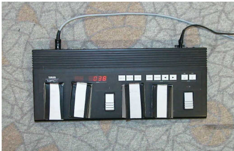
Abbildung 5.7.: Fußpedal für selbstgesteuertes, geräuschfreies Umschalten zwischen Testbeispiel und Referenz
