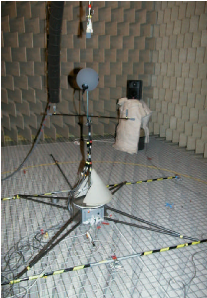
Abbildung 5.3.: Aufbau für Testsignalgewinnung im reflektionsarmen Raum
