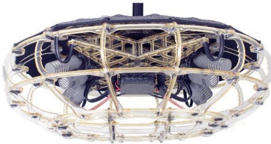
Abbildung 5: ORTF-3D Anordnung im geöffneten Windkorb
