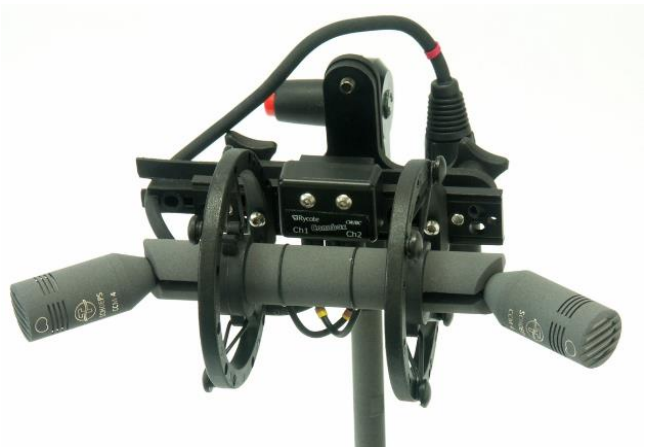
Abbildung 1: Zweikanalige ORTF-Anordnung, hier in elastischer Aufhängung im Windkorb; zwei Nieren, 17 cm, 110°
